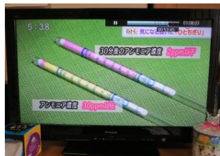
「ひとちぎり」のアンモニア吸着テストです。「ひとちぎり」にてプランク30ppm以上が2ppm以下に激減致します。
